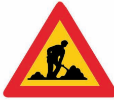
(K - 20) Κίνδυνος λόγω εκτελουμένων εργασιών στην οδό.
