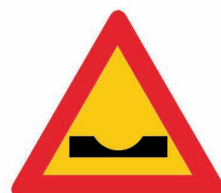
(K - 11) Επικίνδυνο κάθετο ρείθρο (αυλάκι) ή απότομη κοίλη αλλαγή της κατά μήκος κλίσης της οδού.
