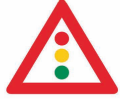
(K - 21) Προσοχή, κόμβος ή θέση όπου η κυκλοφορία ρυθμίζεται με τρίχρωμη φωτεινή σημα- τοδότηση.
